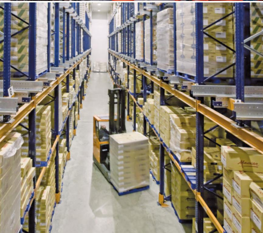
Ejemplo de una instalación con bloques de racks en ambos lados de un pasillo de trabajo (7.2).
