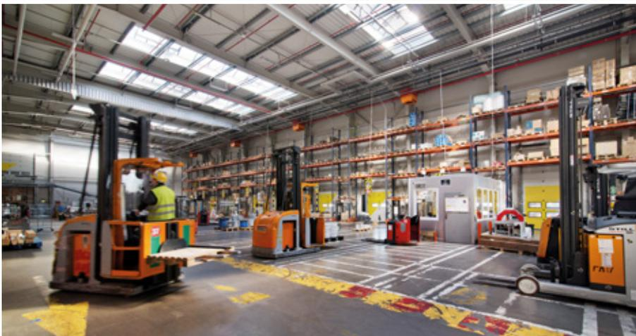
Para hacer picking en los niveles inferiores de las estanterías, los operarios trabajan con máquinas preparadoras de pedidos de cota baja y con elevación.
