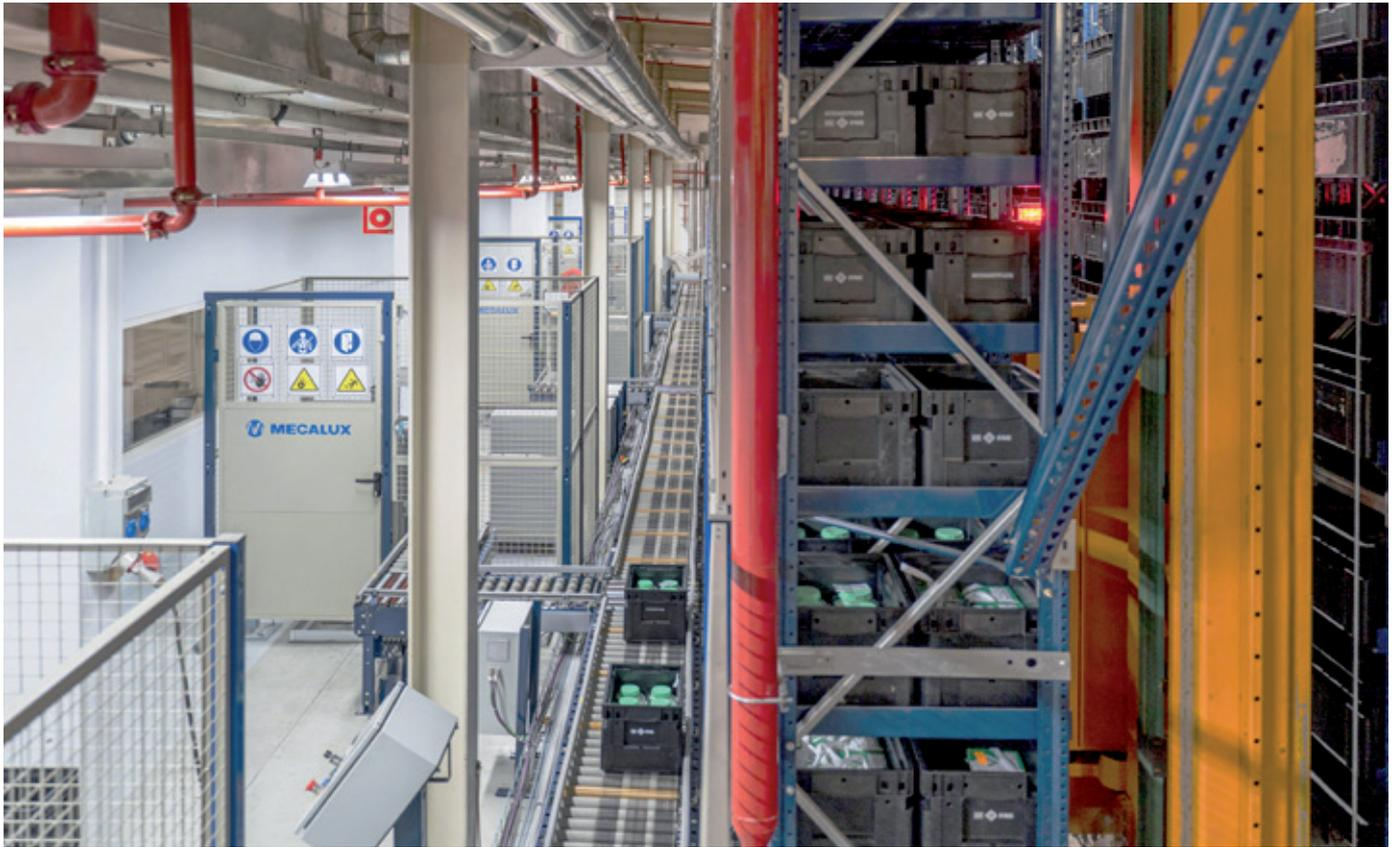
Se han instalado un total de nueve elevadores que conectan ambas plantas del centro, separadas por 4,47 m de altura. Siete de ellos comunican las líneas de producción con el almacén automático y los otros dos descienden la mercancía a la planta inferior, donde se halla la zona de preparación de las cargas y las expediciones.
