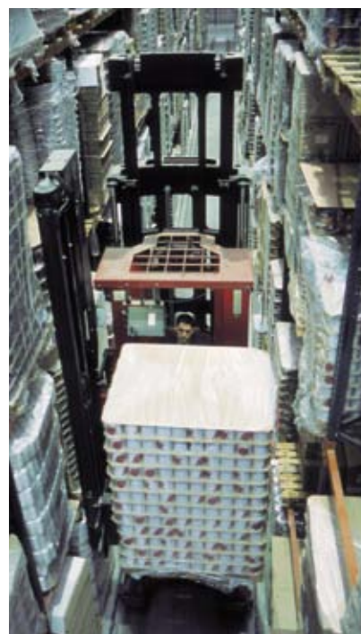
Horquilla en posición de circulación.
