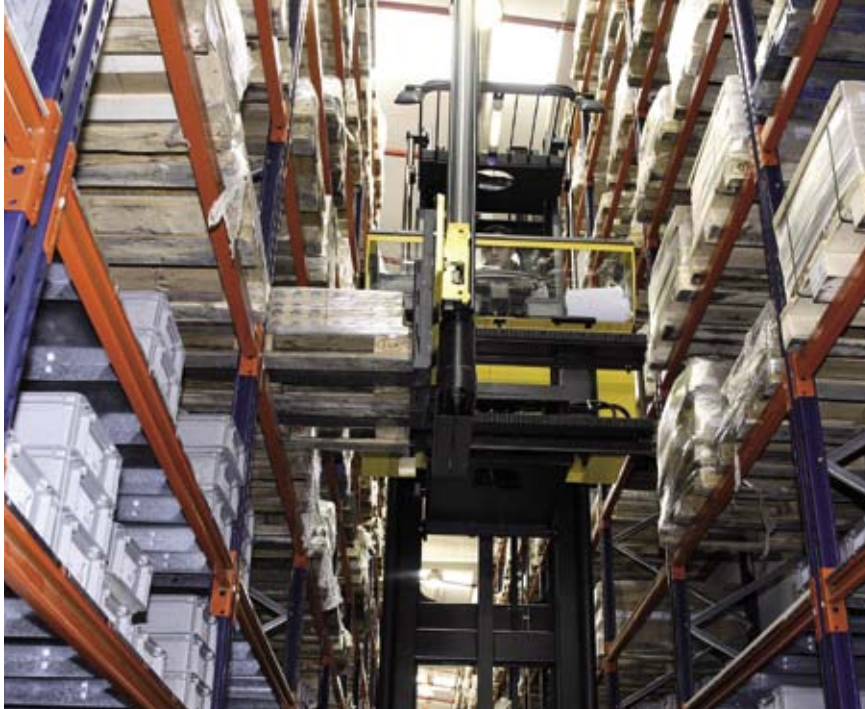
Horquilla en posición de depósito/extracción.
