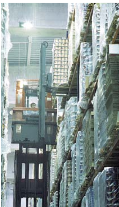
Horquilla en posición de depósito/extracción.
