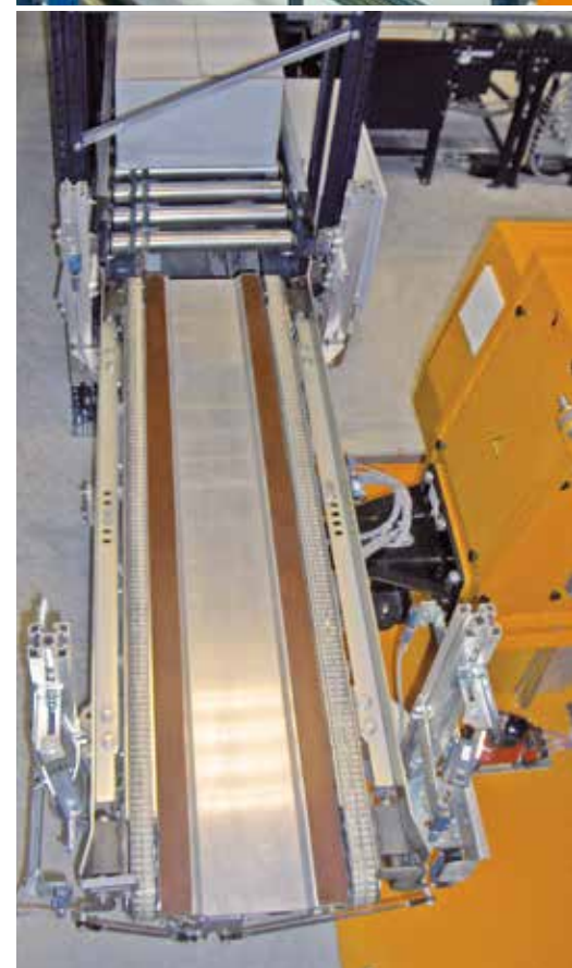
Detalle del sistema de extracción de palas combinadas con correas.
