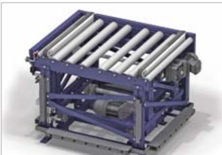
**Transferencia mixta de rodillos y cadenas (TM).** Cambio de dirección a 90° en el avance de las unidades de carga con entrada en el transportador de rodillos y salida en el de cadenas o viceversa. Para llevar a cabo esta operación, combina un transportador de rodillos fijo en la bancada y un transportador de cadenas sobre un bastidor de elevación excéntrica.
