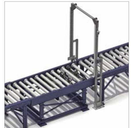
**Puesto de inspección de entradas (PIE).** Equipamiento de control del sistema de transporte cuya misión es comprobar que las dimensiones de las unidades de carga en las entradas cumplan con las especificaciones de la instalación. Al ser el primer control de la unidad de transporte, incorpora un lector de etiquetas de código de barras para la identificación del producto y su posterior registro en el SGA.
