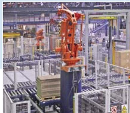
Picking automático con robot despaletizador
