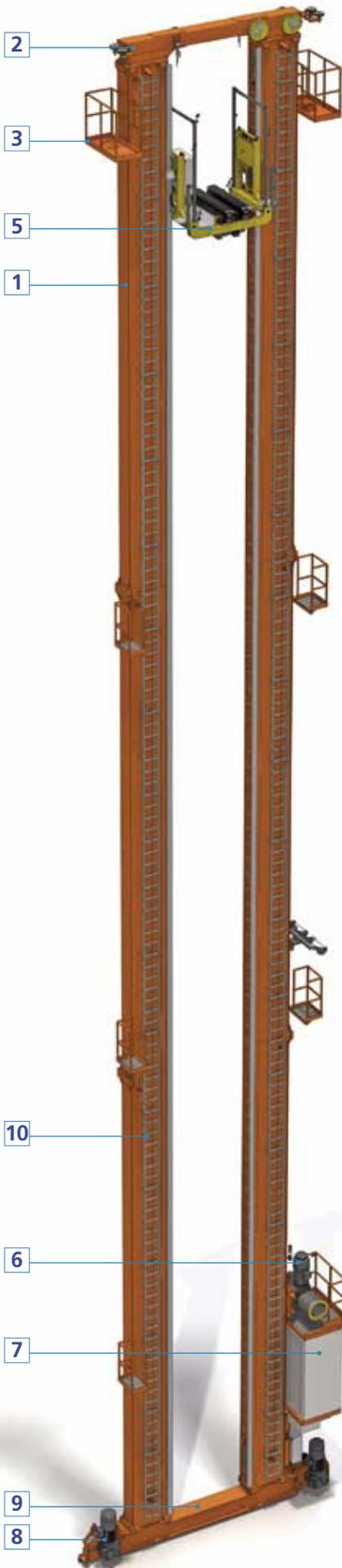
Los transelevadores son máquinas creadas para el almacenamiento automático de paletas mediante movimientos mecánicos automatizados. Se desplazan a lo largo de los pasillos del almacén realizando las funciones de entrada, ubicación y salida de las mercancías.
