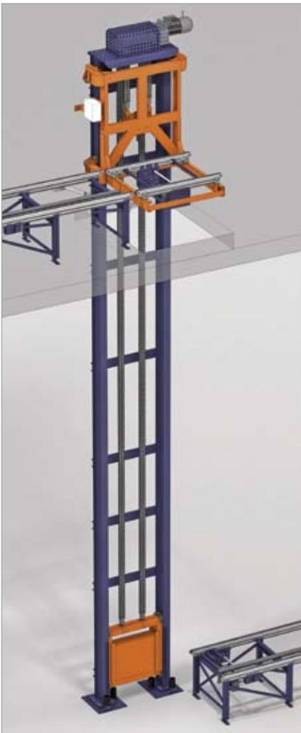
**Elevador de paletas.** Este elemento es fundamental en los circuitos de transporte con distintos niveles, ya que comunica las distintas plantas de una instalación. En la plataforma de elevación se puede instalar un transportador de rodillos o uno de cadenas.
