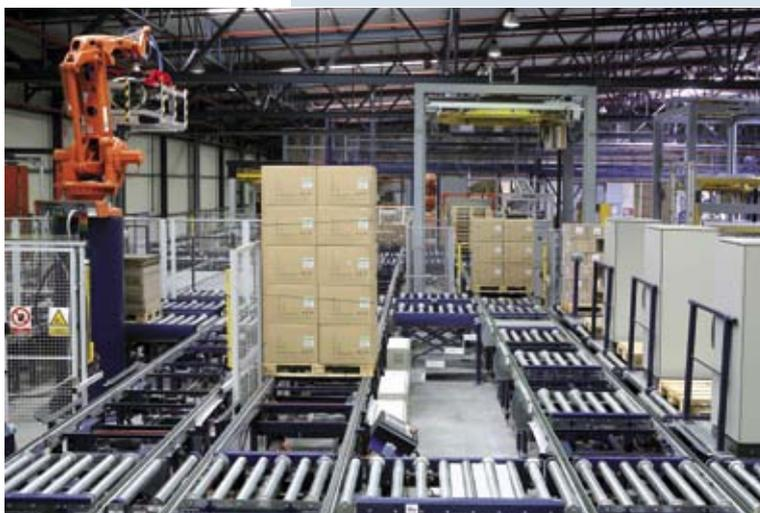
Cuando la cantidad de paletas a manipular sea alta, principalmente con las referencias de alta rotación, se puede hacer el picking de forma totalmente automática mediante el empleo de robots, que guiados por el sistema de gestión de almacenes, preparan los pedidos bien por capas (mantos) o caja a caja.
