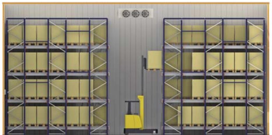
El funcionamiento semiautomático del sistema de acumulación con Radio-Shuttle facilita que el almacenaje de la carga sea rápido y muy preciso. La carretilla deja la carga sobre los carriles y el Radio-Shuttle la desplaza sobre ellos, de forma autónoma, depositándola en su ubicación. El operador ordena los movimientos de carga y extracción a través de un mando de radiocontrol.
