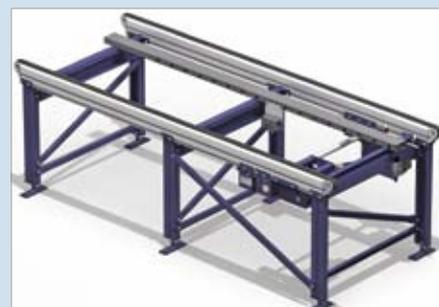
**Transportador de cadenas (TC).** Para la movimentación en sentido transversal a los patines. Es el complemento perfecto del transportador de rodillos ya que la unión de ambos permite describir giros de  $90^{\circ}$  ó  $180^{\circ}$ , facilitando la creación de recirculados y de circuitos de transporte.
