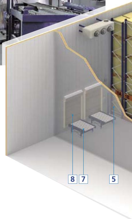
Esta aplicación de paletización sobre bases móviles es un ejemplo que ilustra el notable aumento de capacidad que se consigue con este sistema, aunque siempre dependerá del tipo de carretillas que se utilicen, de las dimensiones de la instalación y del número de calles abiertas que se necesiten.
