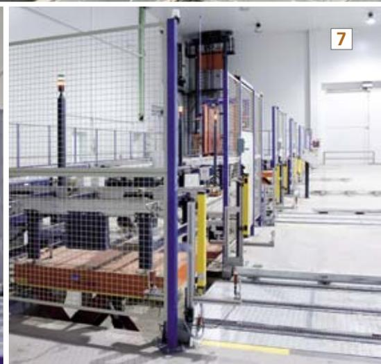
El robot de picking automático permite preparar pedidos de los productos de alta rotación por mantos. Las paletas son alimentadas mediante los transelevadores y los transportadores de la cámara automática.
