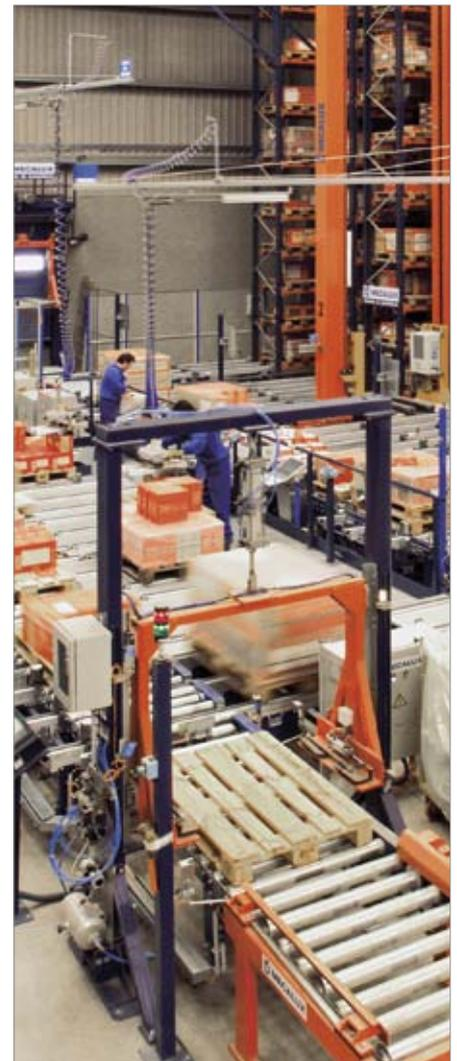
**Remontador de paletas.** Permite colocar paletas (principalmente las de baja calidad) sobre paletas esclavas de buena calidad, para evitar así incidentes en el transporte y almacenaje. Va combinado con apiladores o desapiladores de paletas.
