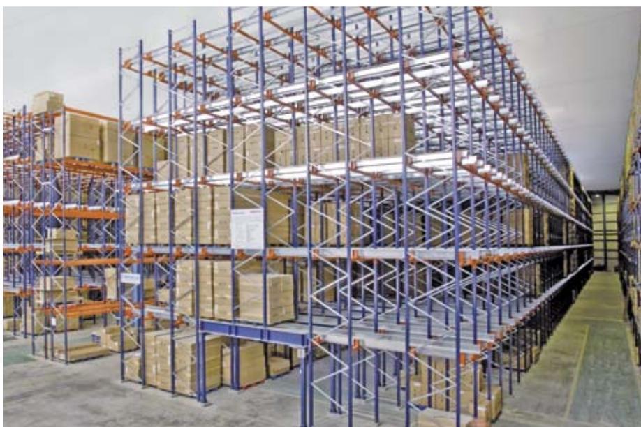
Ejemplo de aplicación de un almacén de acumulación con Radio-Shuttle que dispone de dos transportadores, uno de entrada y otro de salida. Así se optimizan los tiempos de ejecución de los operadores.
