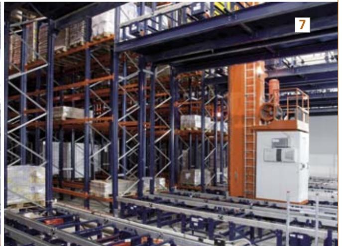
La zona de picking automático dispone, del robot pórtico de dos ejes, de lanzaderas y transportadores automáticos para conseguir los flujos requeridos.
