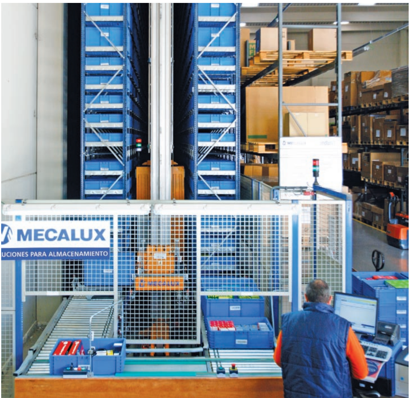
Detalle de puesto de picking frontal con cabecera simple y doble pala extractora.
