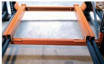
Los carriles de rodadura junto con los carros se apoyan sobre los largueros de los racks. Éstos están montados con el desnivel necesario para el correcto desplazamiento de los carros.
