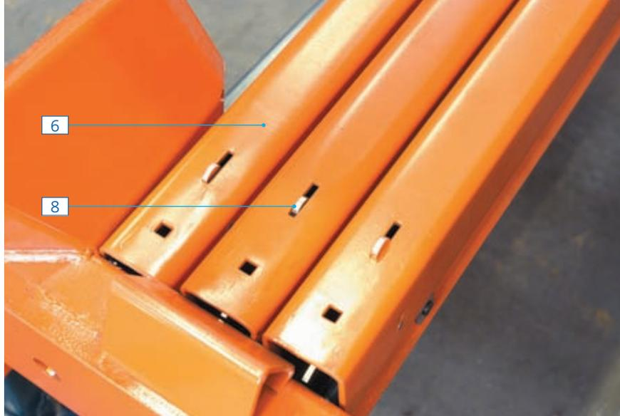
Cada carro, además de los elementos de rodadura, dispone de un gatillo de seguridad que impide su desplazamiento si el pallet no ha sido correctamente apoyado.
