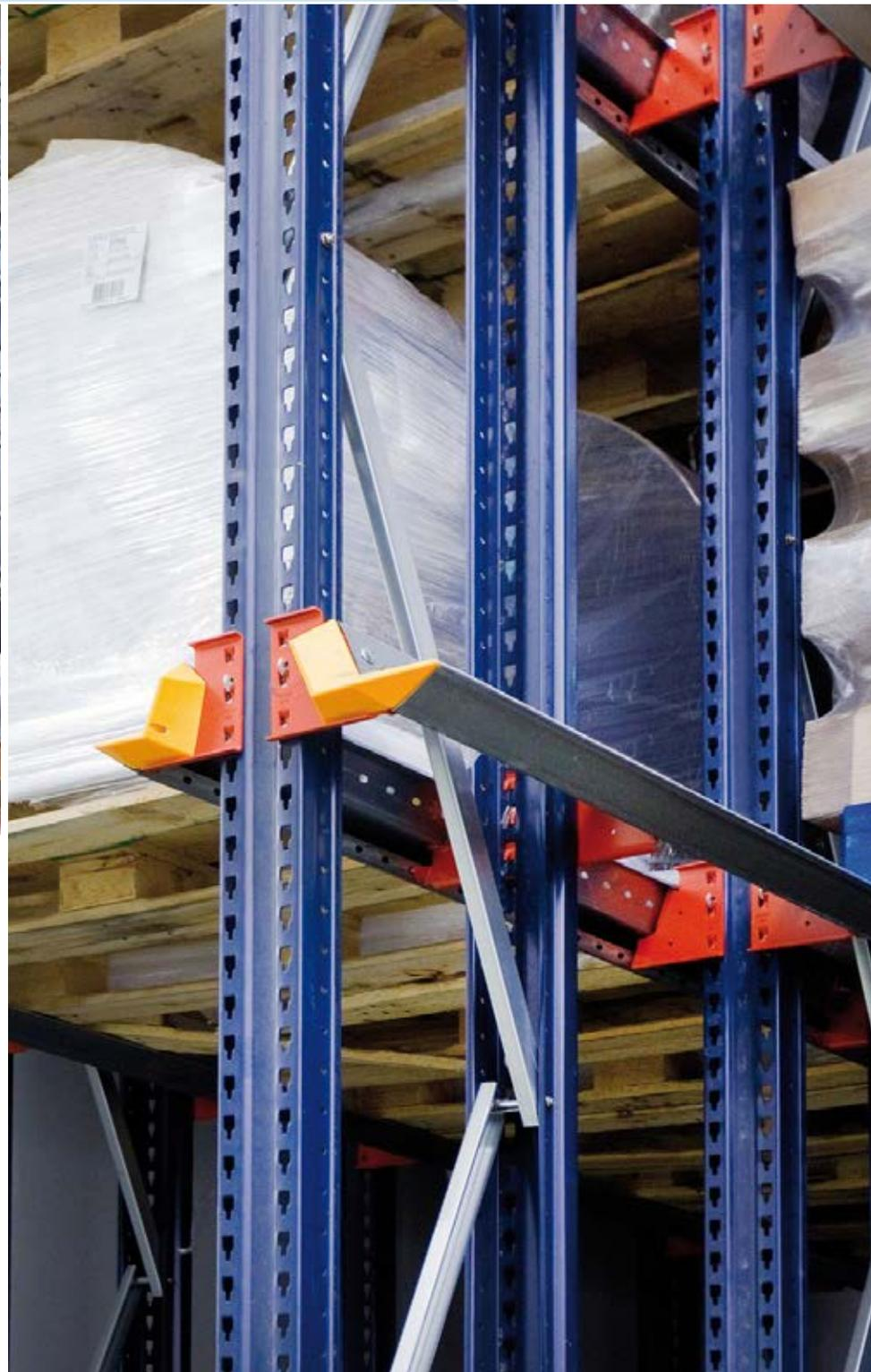
Los puntales utilizados como resultado de dichos cálculos se han desarrollado con geometrías específicas para cada tipo de instalación y cubren todas las necesidades de almacenamiento en función de la altura, la carga y la distribución de la instalación (figura 8).
