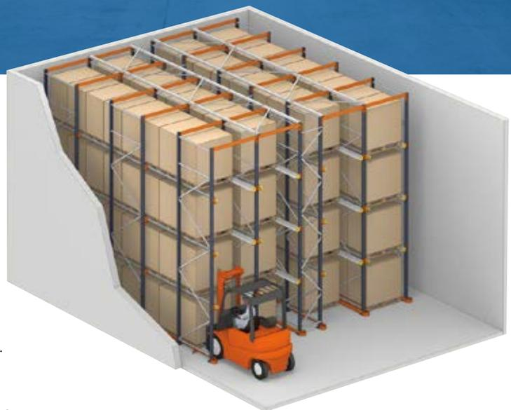
Cada calle de carga está dotada de carriles de apoyo a ambos lados, dispuestos en distintos niveles, sobre los que se depositan los pallets. La elevada resistencia de los materiales que forman este tipo de racks permite el almacenamiento de pallets de gran carga.
