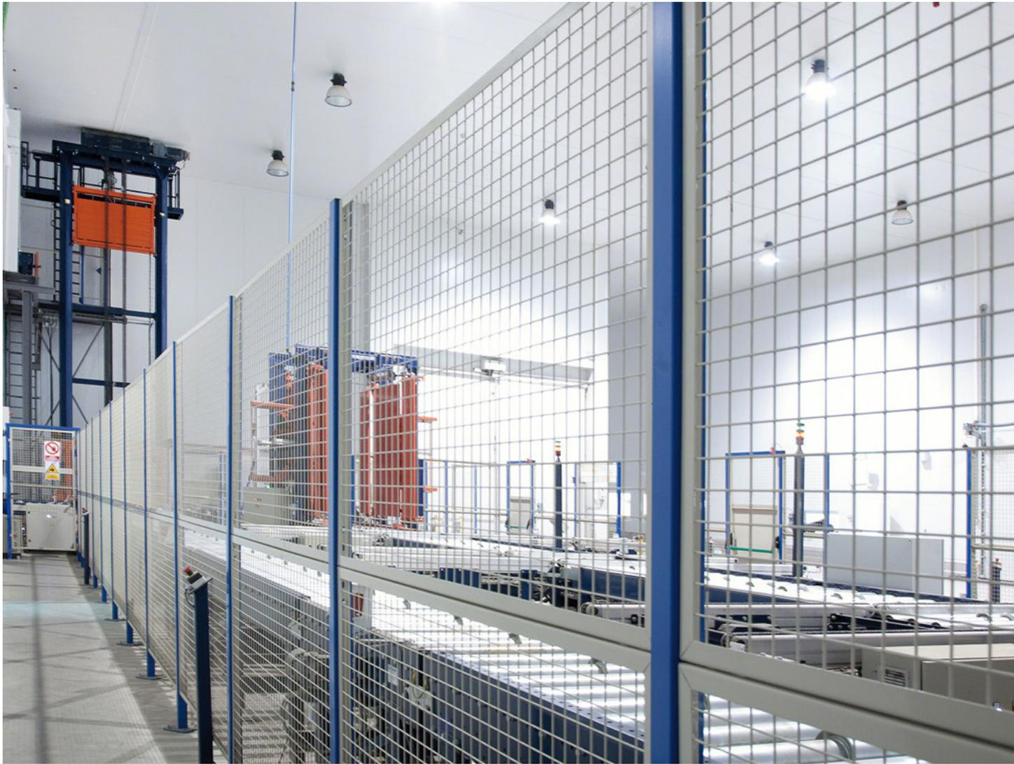
**Los cierres modulares de seguridad crean un espacio protegido en el área de trabajo de instalaciones automáticas y robots de fabricación.**
