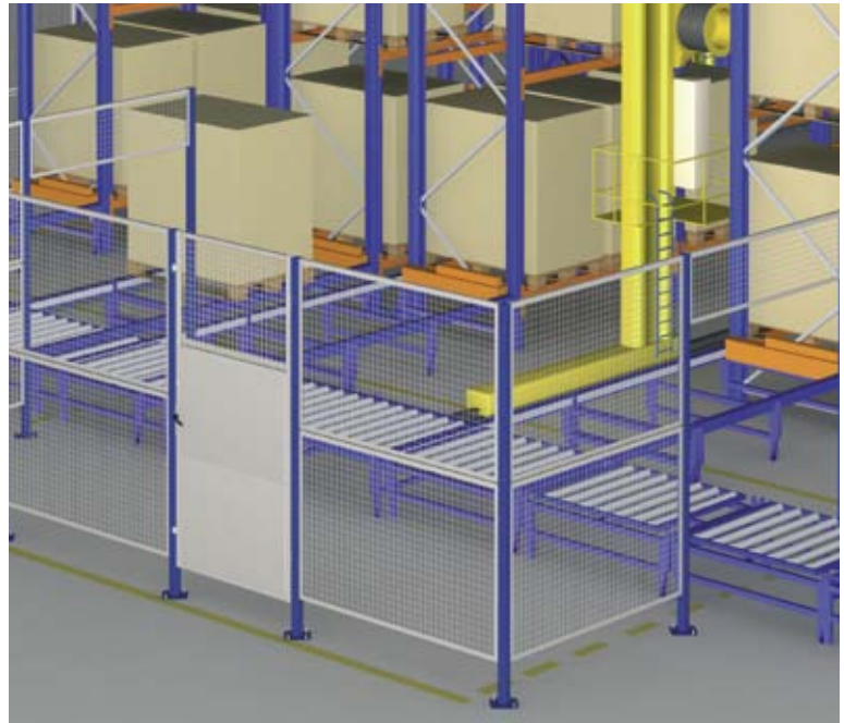
Protección de las zonas de caminos de rodillos.
