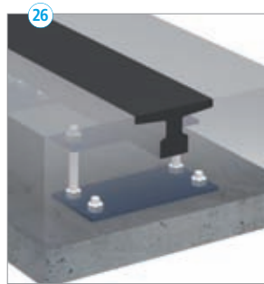
Carril de rodadura.
