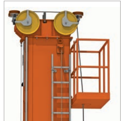
Barandilla de seguridad.
