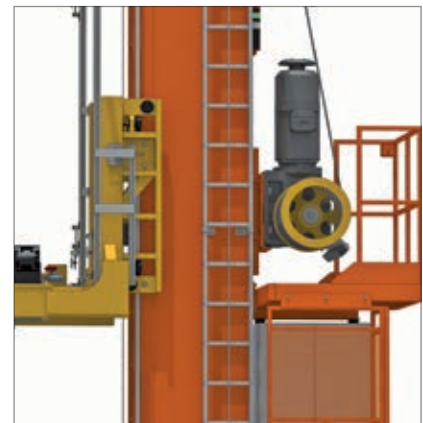
Escalera de mano y plataforma de mantenimiento superior.
