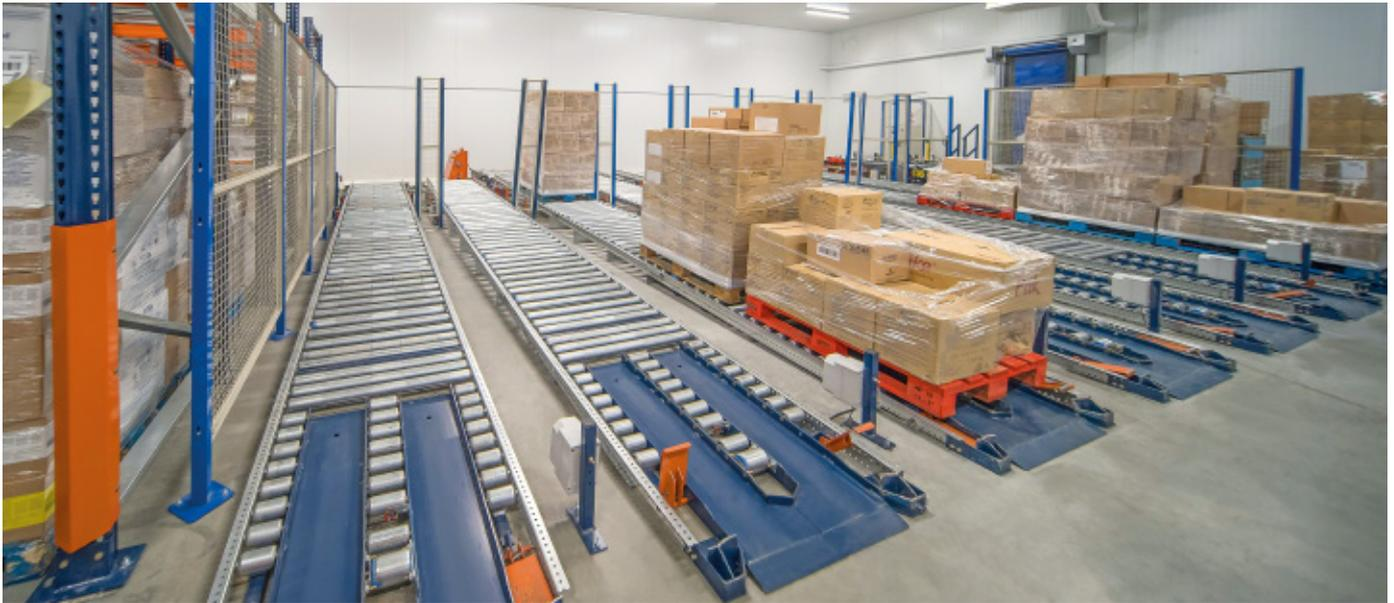
**Seguridad de la mercancía.** La zona de expediciones también trabaja a temperatura controlada para no romper la cadena de frío. Además, retenedores, rodillos de freno y otros dispositivos instalados en los canales de precarga controlan de forma automática la velocidad y parada de los palets sin que se produzcan atascos o choques.
